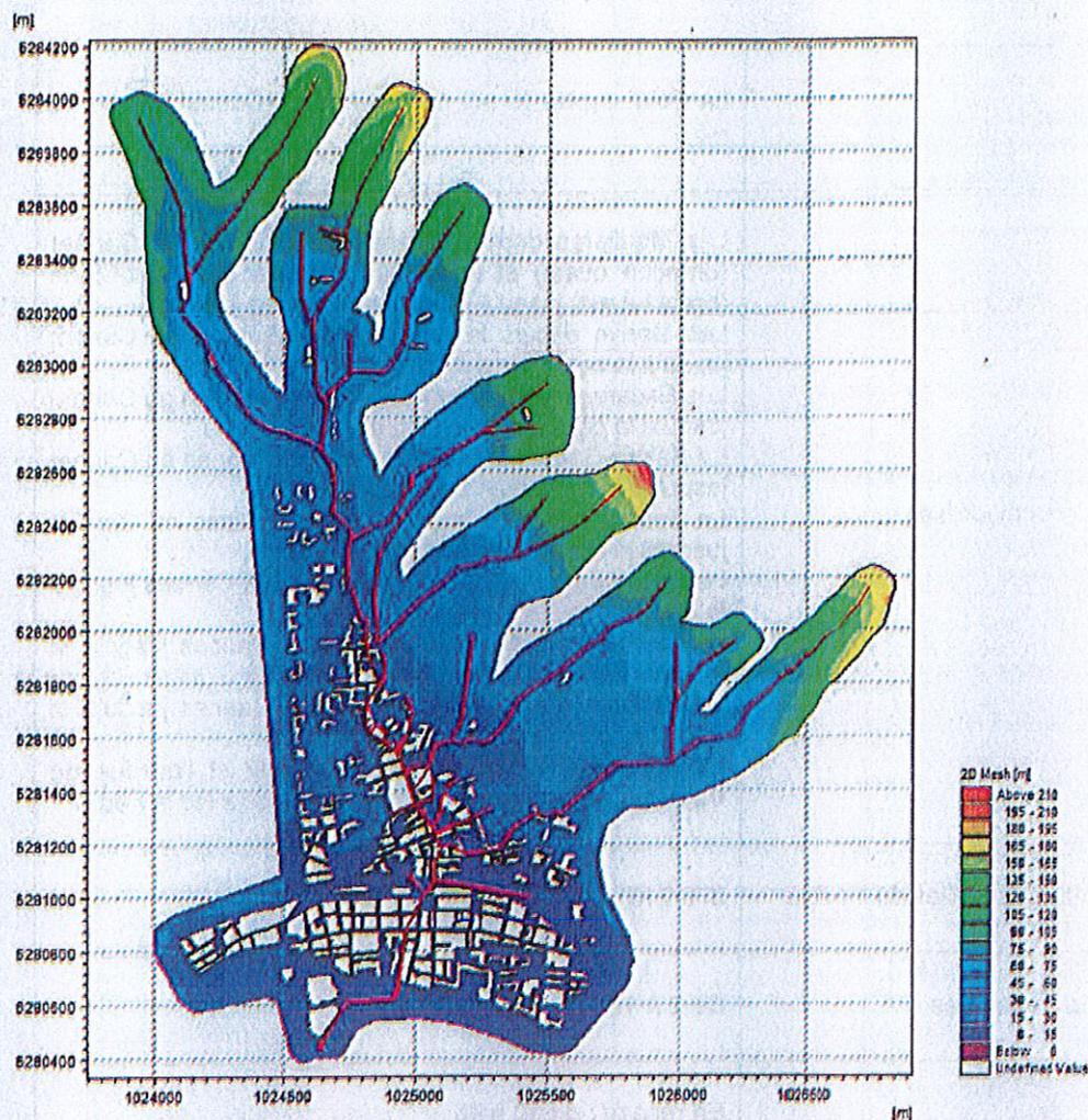
Figure 42 : Vue globale du modèle du vallon de la Foux et ses affluents
