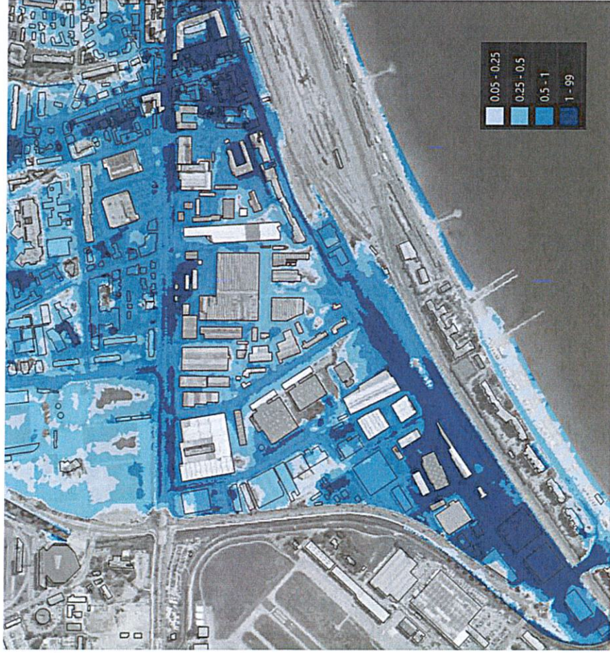
Figure 13 : Hauteurs d'eau en état actuel (à gauche) et en état projeté (à droite) pour la crue de référence octobre 2015
